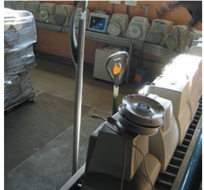
Banda transportadora para test de monitores
