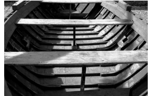
Cuadernas embarcación de madera. Foto propia.
