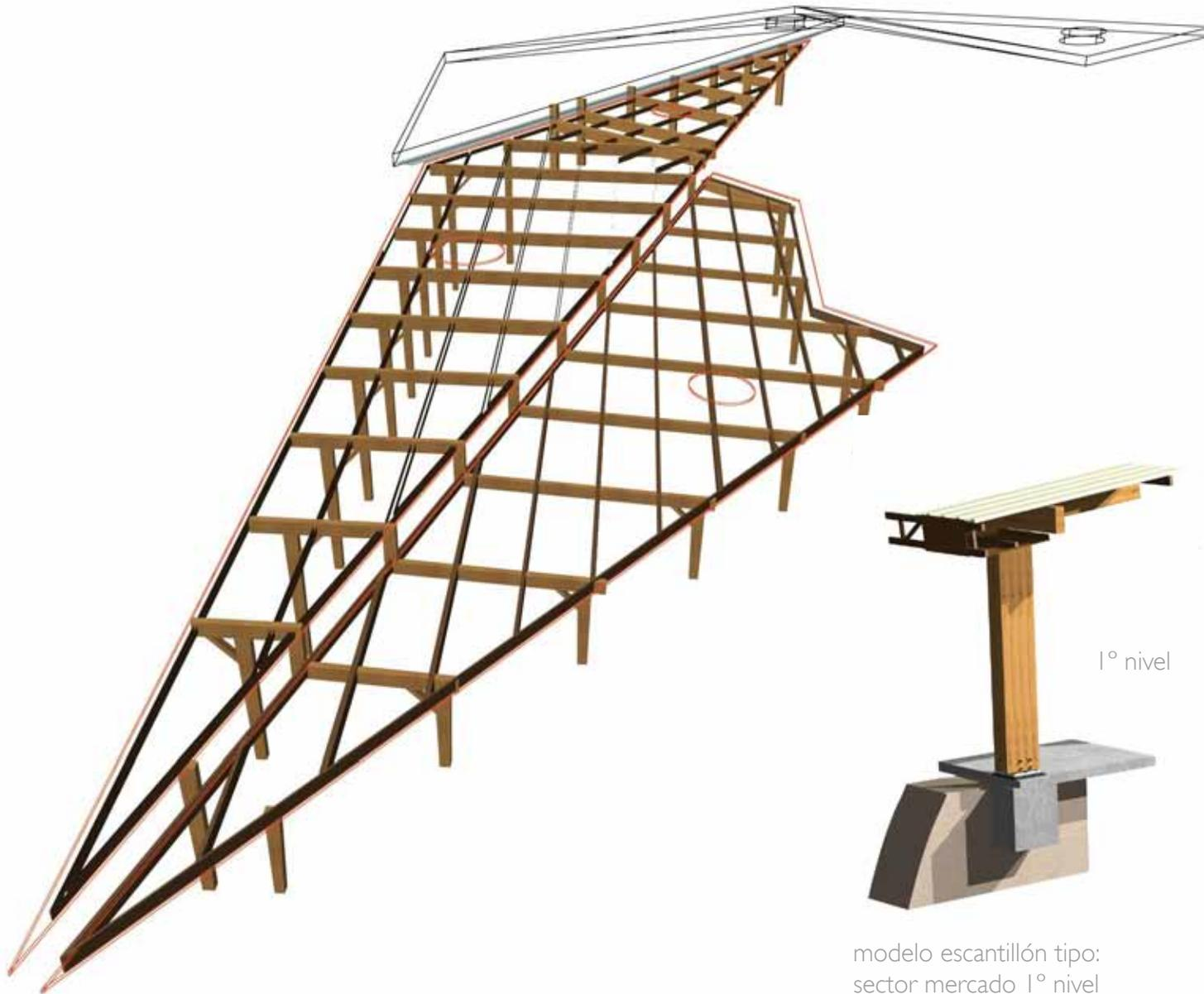
modelo estructura cubierta
