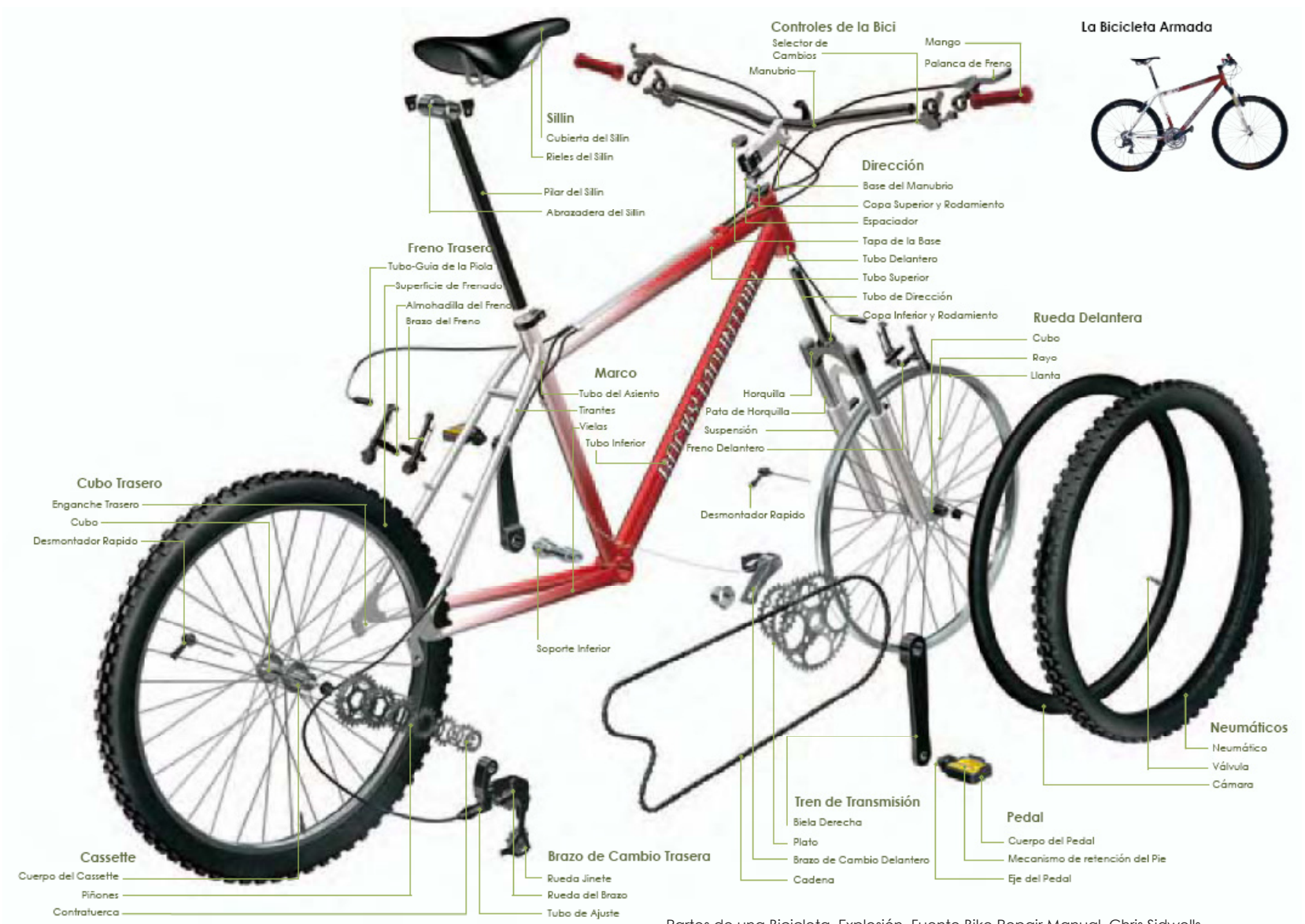
Partes de una Bicicleta, Explosión, Fuente Bike Repair Manual, Chris Sidwells.
