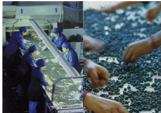
Fig. Mesas de selección, donde el grano de la uva es separado de su escobajo o de granos en mal estado. Fuente: Martínez, Mariana. “El Vino de la A a la Z”. Santiago de Chile 2005, Editorial Planetavino. pp. 98
