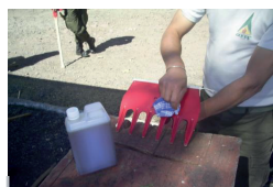
6 Pintar la sección metálica y barnizar periódicamente el mango.
