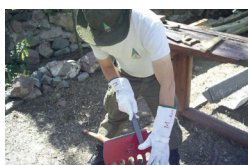
4 Mantener los filos con lima y piedra de asentar
