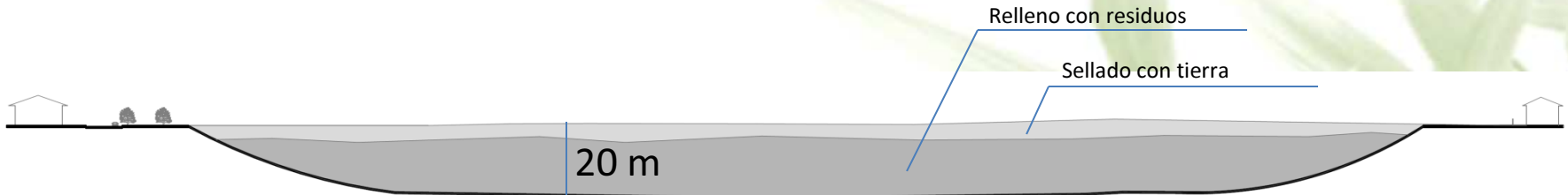
Corte transversal esquemático del relleno
