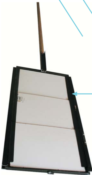
Las palas giran sólo en un sentido hasta los 90° en donde topan con el marco.
