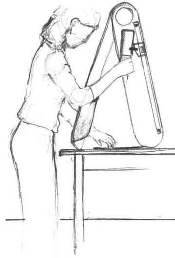
Para dejar la ampliadora a la altura deseada, se diseñó un sistema de fijación a presión, para esto se considera una pieza que al rotar en un eje excéntrico, cuando se abre se suelta y cuando se cierra presiona la cara del eje.
