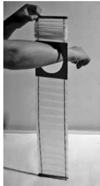
Para lograr el movimiento de giro del antebrazo, se utiliza la posibilidad de torsión del sistema.
