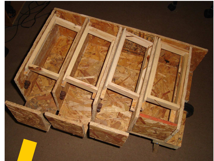
Detalle sistema de Cajones y soporte de marcos, estos cajones se abren al exterior albergando en ellos los moldes con cera
