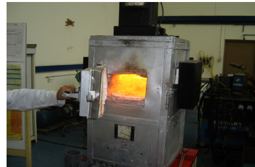
Horno Fundición (Metalurgia, UTFSM Valparaiso)
