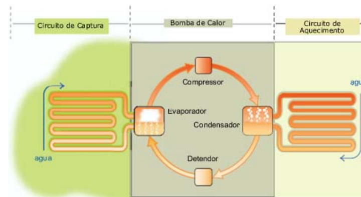
Funcionamiento bomba de calor geotérmica
