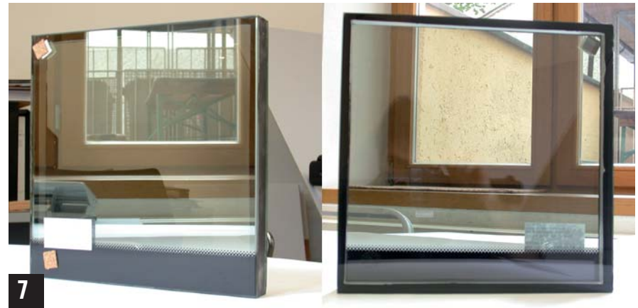
Imagen N°31. Estudios de reflectividad externa y de admisión de luz de las muestras más interesantes
