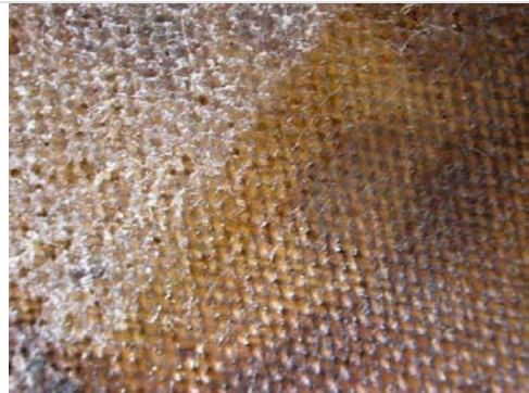
• Obsérvese la diferencia entre el lado limpio y el que tiene cera.
