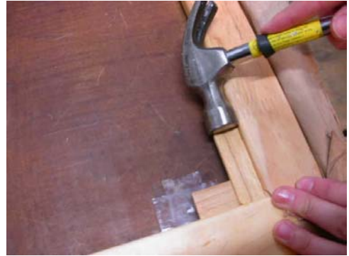
• Colocación de las cuñas.
