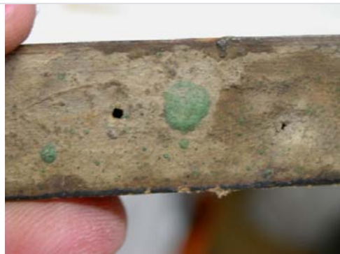
•Detalle de hongos en la cinta pegada en la madera.
