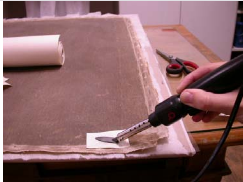
• Planchado del papel absorbente.
