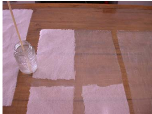
• Colocación de C.M.C. en el papel japonés sobre un vidrio.
