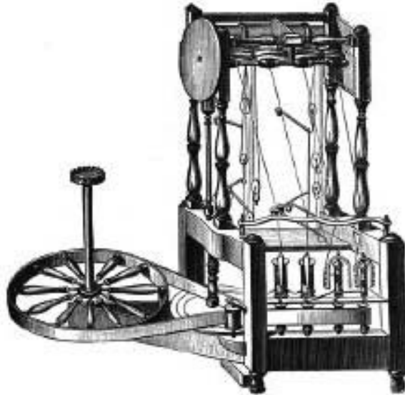
Máquina de hilar de Arkwright llamada "waterframe" 8 .
