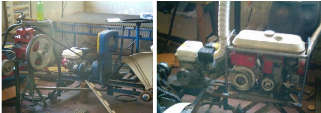
Figura 1 a) Dinamómetro en base a bomba de agua b) Dinamómetro en base a generador
