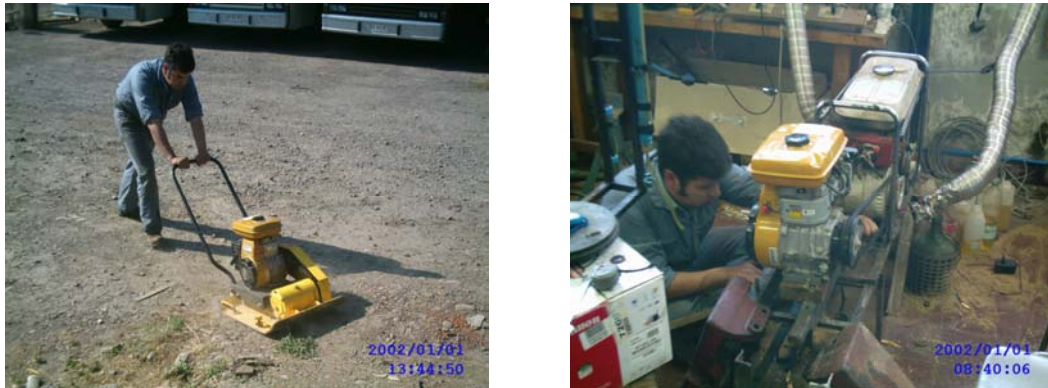
Figura 15 a) compactadora con motor usado. b) ensayos con motor usado.
