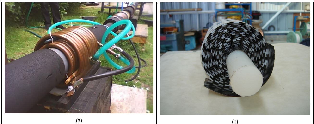
Figura 4.5 a) Bobina Resonante Real (modelo de dos capas) . b) Susceptor Magnético Real.
