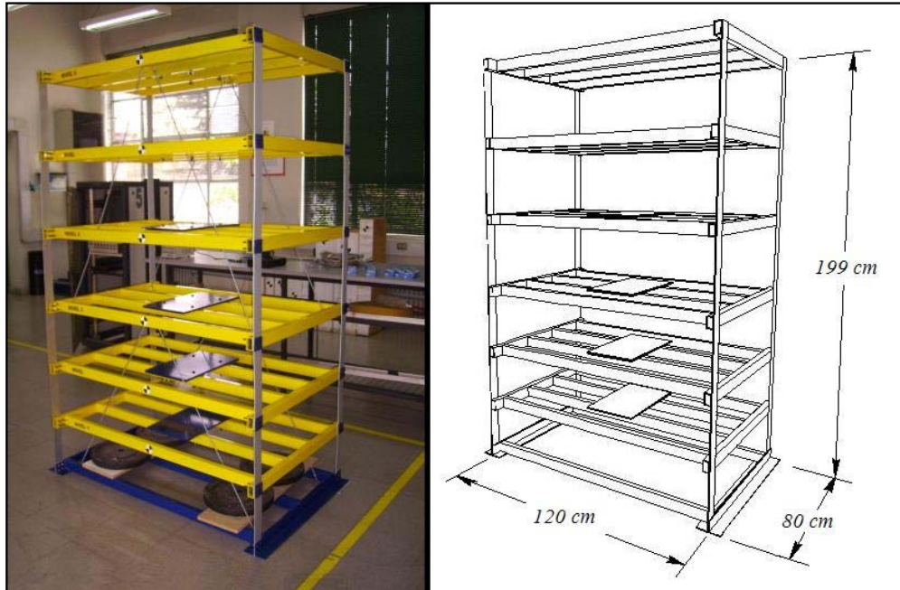
Figura 6. 2. Estructura de 6 niveles a la cual se realizará el procedimiento de actualización. Modelo Realizado en el Laboratorio de Estructuras de la Universidad de Chile. A la derecha un esquema dimensionado.
