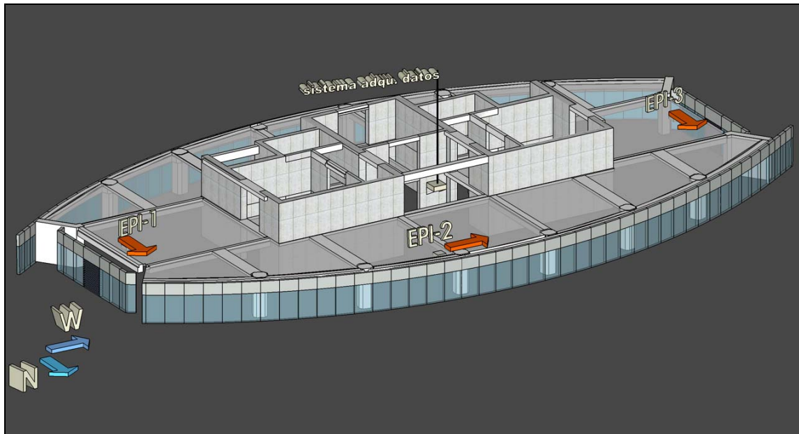
Figura 5. 57. Ubicación y orientación de sensores (EPI) y sistema de adquisición de datos ( Logbook ) en piso 20 del edificio Titanium La Portada.
