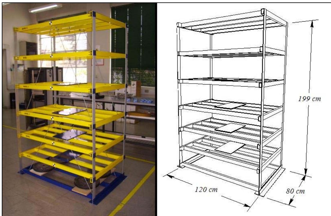
Figura 3. 11. Modelo estructural de 6 niveles.
