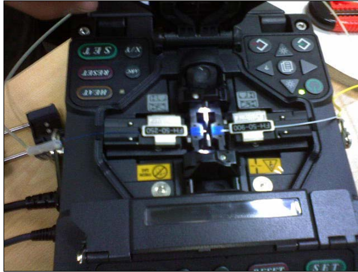
Fig. 3.7: Proceso de Fusión al Arco en dispositivo modelo FSM-17R fabricado por Fujikura®.
