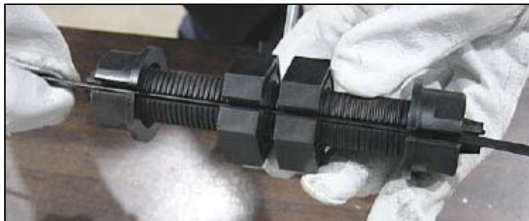
Fig. 4.5: Abrazadera plástica fabricada por NTT. Arriba: con fibra embossing. Abajo: con otro tipo de fibra sensora.
