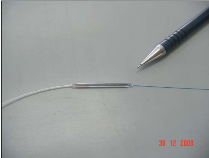
Fig. 3.22: Fusión fibra de acercamiento con fibra sensora embossing, mediante fusión al arco (ver Fig. 3.7)
