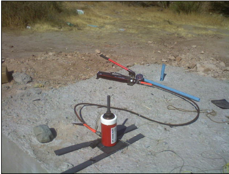
Fig. 4.12: Instalación equipo de carga en terreno para ensayo falla tipo bloque (modelo B de ensayos).
