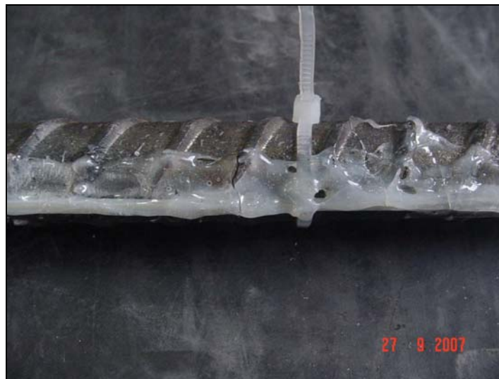
Fig. 5.57: Perno instrumentado con fibra luego de finalizar el ensayo. Se observa el pegamento Poxipol agrietado
