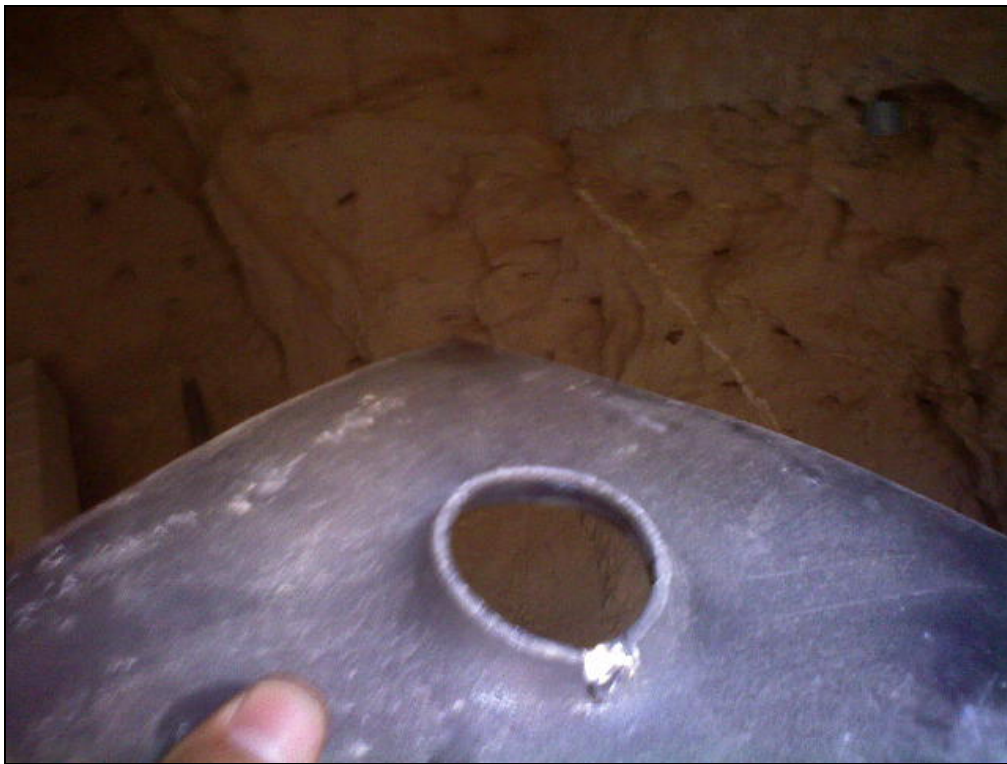
Fig. B. 6: Placa de sujeción deformada después de un ensayo en falla tipo bloque.
