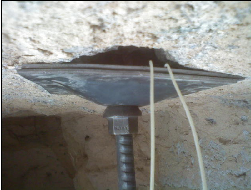
Fig. 4.15: Detalle instalación placa inferior (bajo sector delgado losa). Ensayo falla tipo bloque (modelo B de ensayos).
