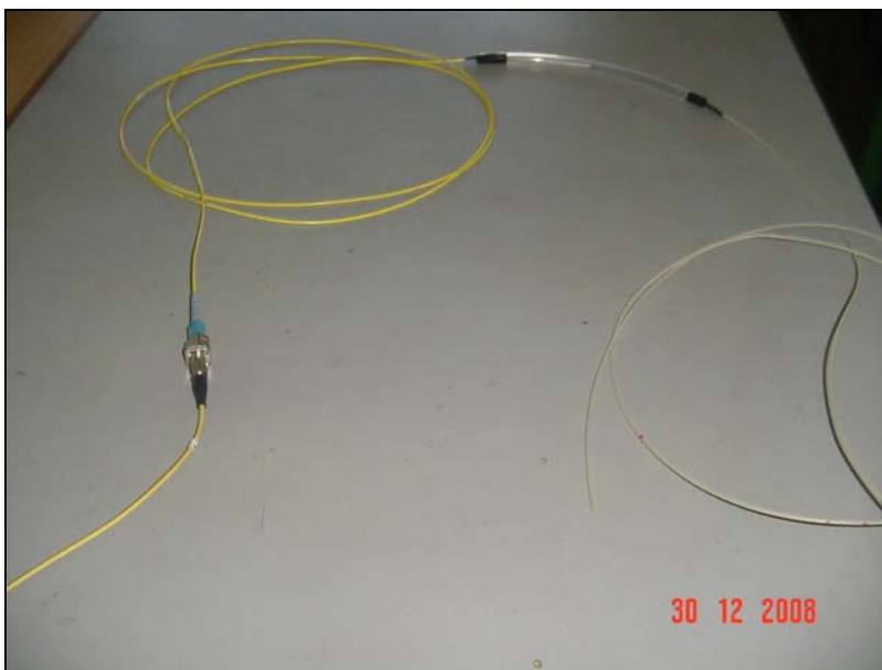
Fig. 3.23: Sistema de fibras típico. Izquierda: fibra de conexión de entrada al analizador. Al medio: fibra de acercamiento. Derecha: fibra sensora embossing.
