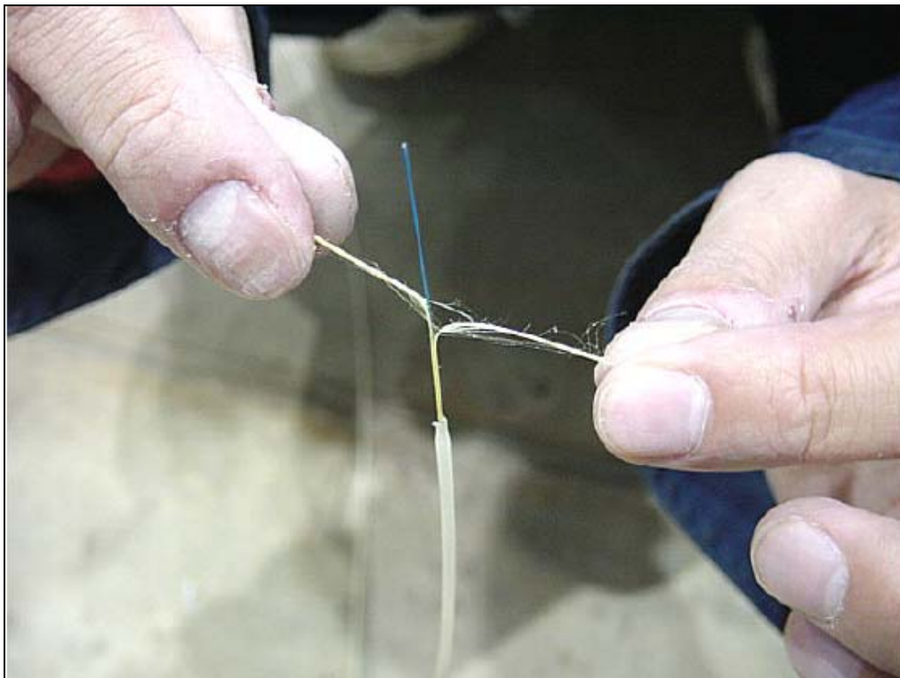
Fig. 3.18: Procedimiento de desenvoltura Fibra Óptica Sensora Tipo Embossing Surface (NTT, 2007).
