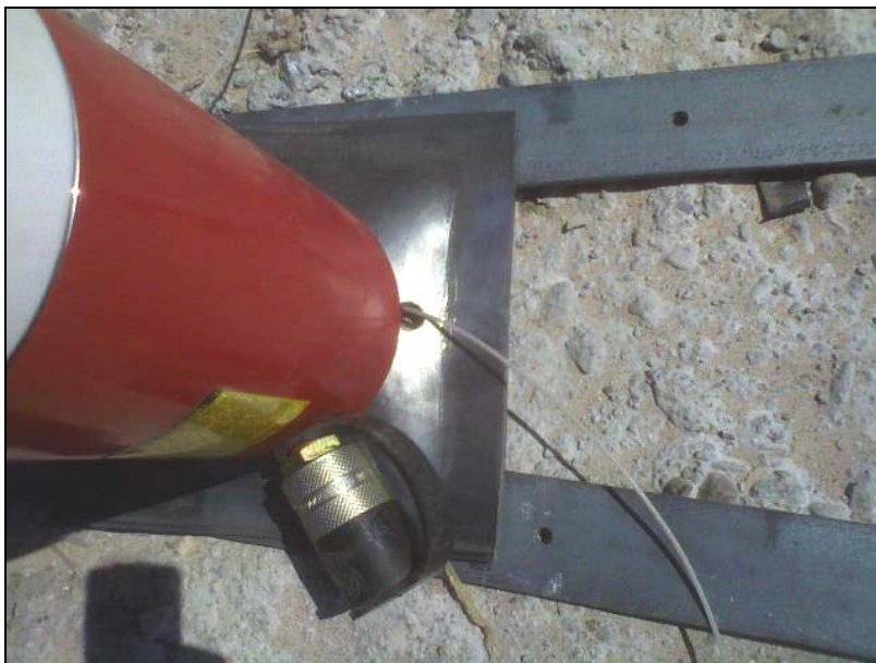
Fig. 4.14: Entrada y salida de fibra a través de la placa de sujeción.
