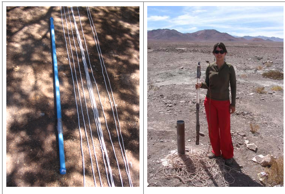
Figura 5.1 Tipos de muestreadotes utilizados. Izq.: Instrumento de PVC utilizado. Der.: “Bailer” clásico modificado.
