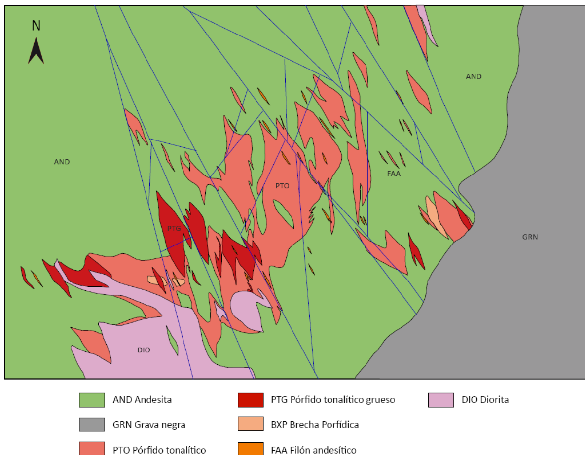
Figura 3.3 Litología y estructuras en Inca de Oro. Planta 1500 m. Modificado de Baeza et al , 2008.
