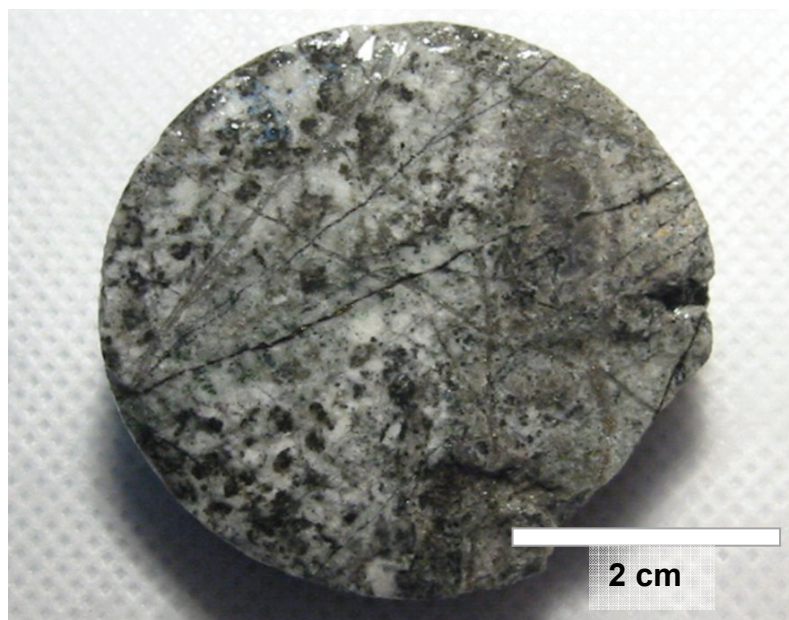
Figura 32. Muestra de testigo del sondaje AM-02, a 228 metros de profundidad, que muestra al Pórfido Diorítico Amos afectado por fuerte alteración biotítica y vetillas de cuarzo tipo “B” con mineralización de calcopirita + pirita. Calcosina aparece como sulfuro secundario.
