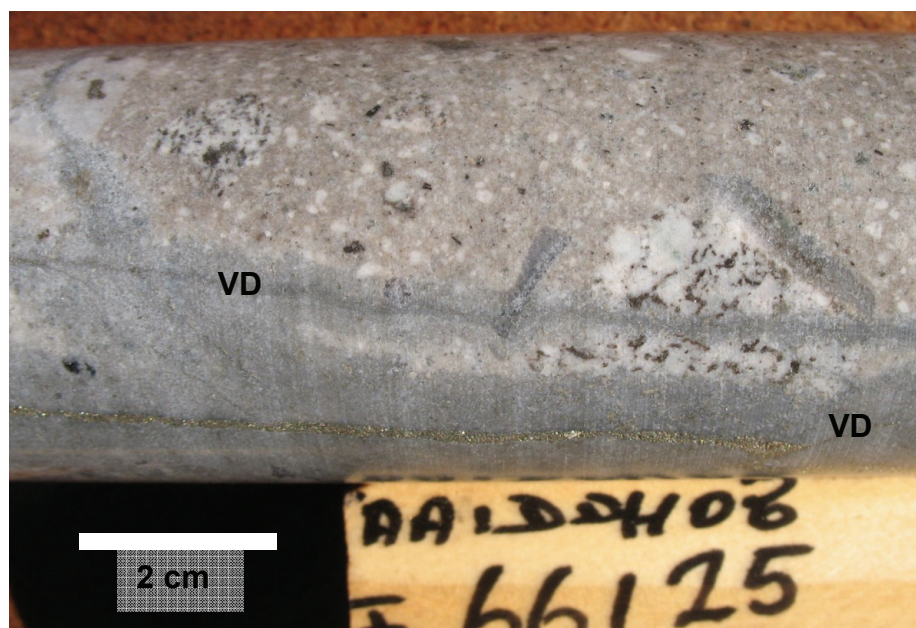
Figura 40. Toba dacítica brechosa en muestra de testigo del metro 661 del sondaje AADDH-08, con efectos de alteración potásica, conteniendo clastos subredondeados de pórfidos interminerales con vetillas de cuarzo y anhidrita. Note la presencia de vetillas de pirita tipo "D" (VD) atravesando a los clastos y a la matriz tobácea.
