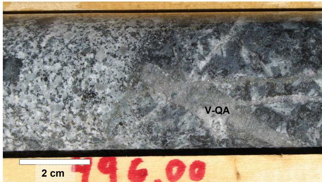
Figura 12. Foto del sondaje AADDH-06, a 496 metros de profundidad, que muestra un contacto entre el Pórfido Granodiorítico (lado izquierdo) y andesitas ocoíticas correspondientes a la Formación Los Pelambres-Juncal (lado derecho). Notar como los eventos tempranos de alteración y mineralización en la andesita son truncados en el contacto con el pórfido intermineral. Ambas litologías se encuentran afectadas por fuerte alteración potásica y por vetillas de cuarzo tipo "A" (V-QA).
