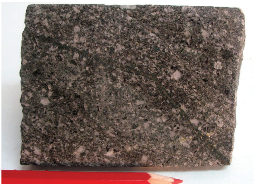
Figura 15. Muestra de testigo del sondaje AADDH-02, a 79 metros de profundidad, que muestra al Pórfido Diorítico Fino afectado por fuerte alteración biotítica. Note la vetilla de biotita temprana atravesando la roca, sin halo de alteración visible a escala macroscópica.
