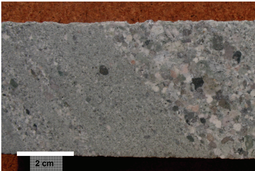
Figura 22. Foto del sondaje AADDH-09, a 268 metros de profundidad, que muestra la toba brechosa con estratificación paralela.
