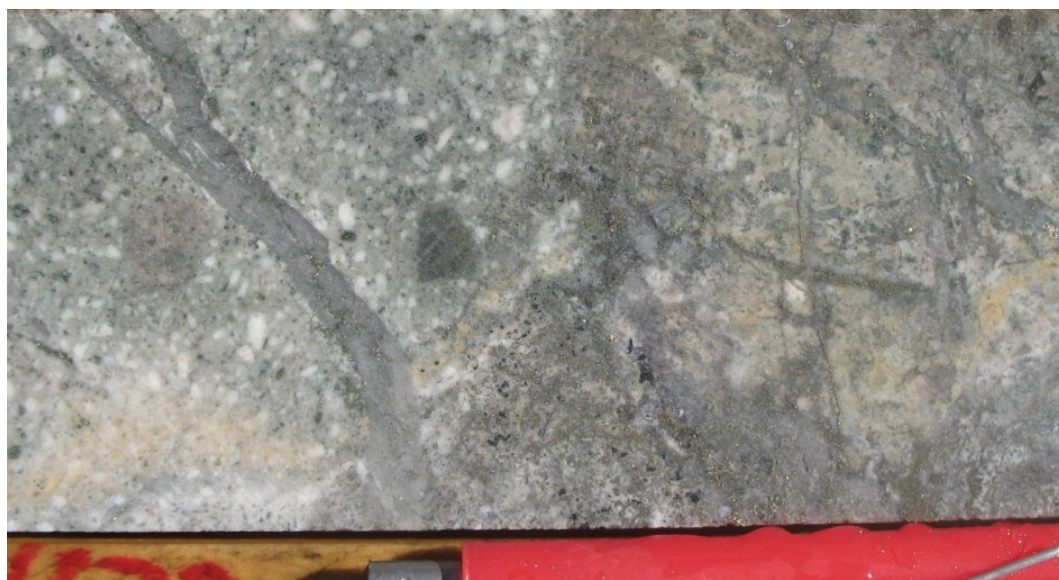
Figura 9. Muestra de testigo del sondaje AADDH-06, a 432 metros de profundidad, que muestra al Pórfido Diorítico Andrés (lado izquierdo) intruyendo a andesitas porfíricas con fuerte alteración potásica (lado derecho). Notar la presencia de xenolitos de andesitas en el borde del pórfido.
