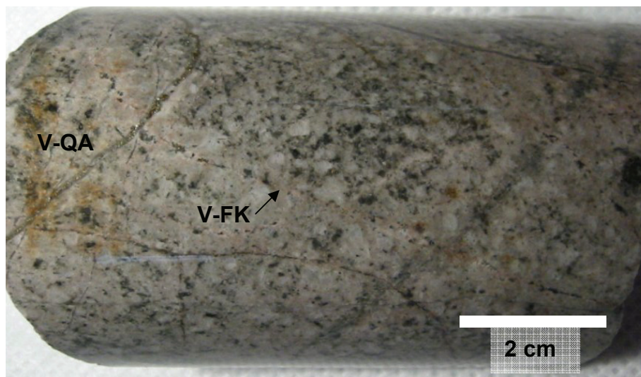
Figura 29. Pórfido Cuarzo Monzonítico en el metro 228 del sondaje AM-3, que muestra fuerte alteración a feldespato potásico y biotita, con desarrollo de vetillas de feldespato potásico (V-FK), cortadas por vetillas de cuarzo tipo A.
