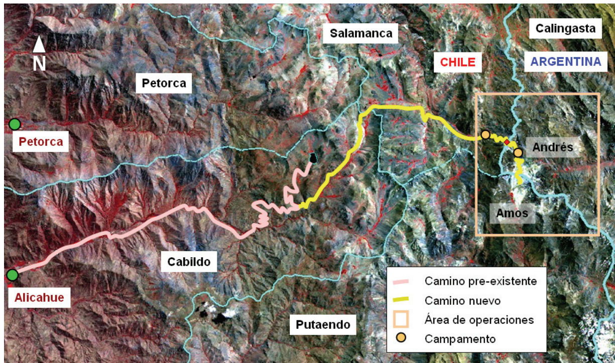
Figura 2. Imagen Aster con la ubicación del área de operaciones del Proyecto Amos Andrés. La línea rosada muestra el acceso rehabilitado (45 km) y la amarilla, el construido (39 km). Las líneas celestes segmentadas muestran los límites comunales, y la sólida, el límite internacional. El rombo rojo señala el Hito Paso de La Honda o del Portillo.
