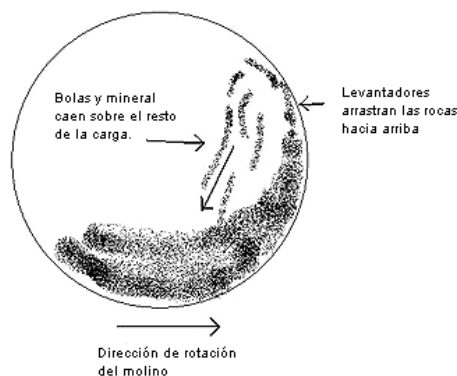
Ilustración 16: Principio de funcionamiento molino SAG.
