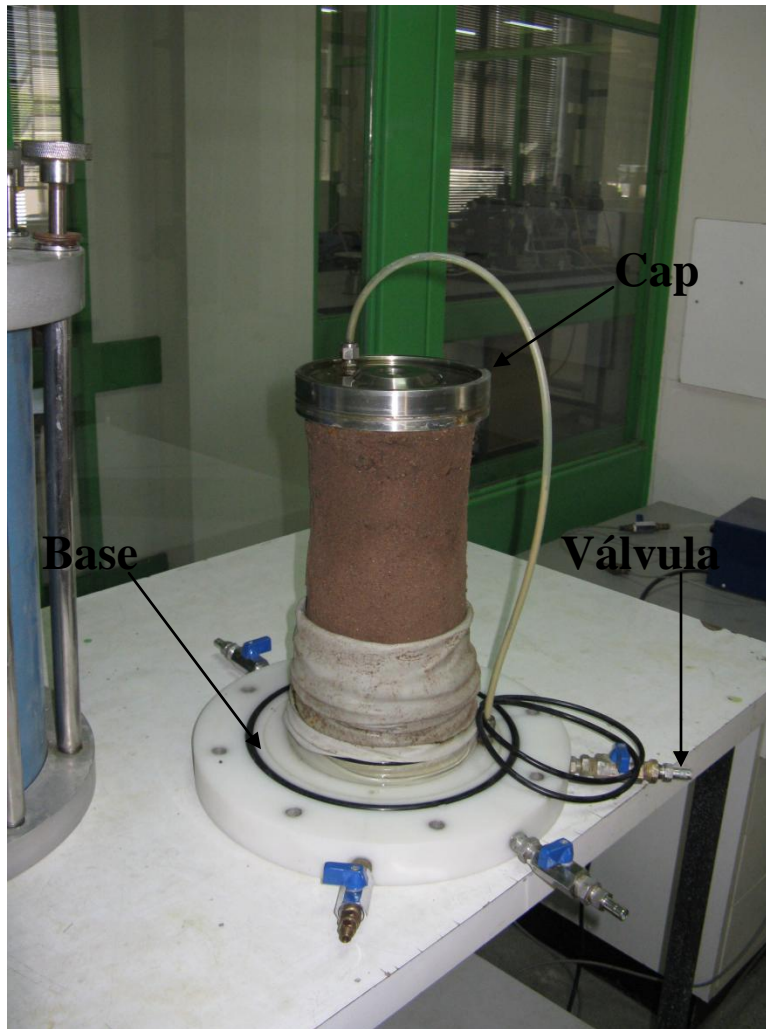
Figura 4.2: Permeámetro y muestra ensayada
