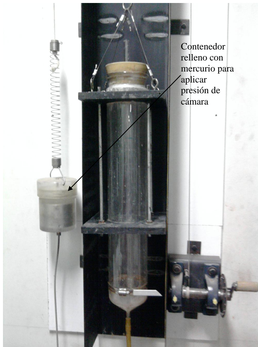
Figura 4.6: Aplicación de presión de cámara
