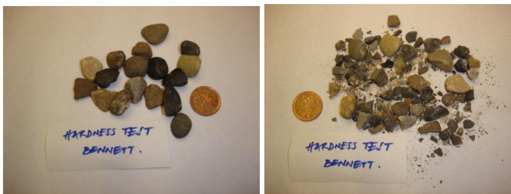
Figura 5.19: Ensayo de Dureza sobre partículas tomadas aleatoriamente del Núcleo de la represa WAC Bennett. Antes (izq.) y después (der.) del ensayo.
