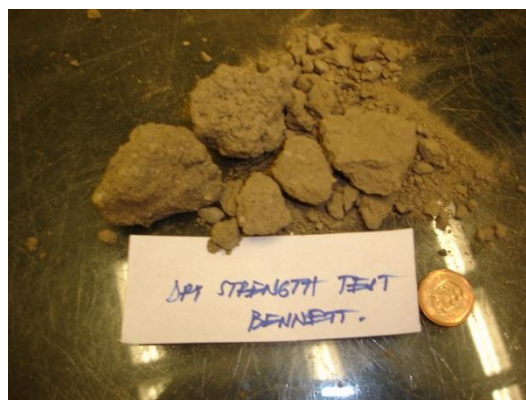
Figura 5.20: Ensayo de Resistencia seca en el material tipo Nucleo – Estado final
