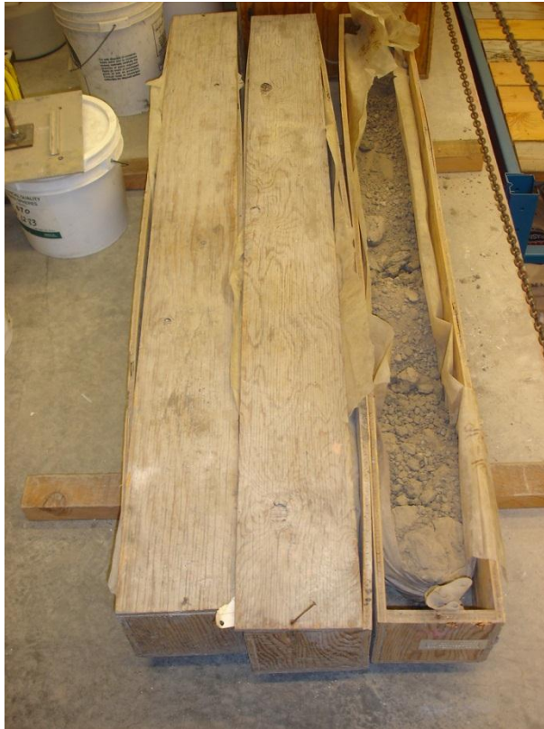
Figura 5.17: Foto de las cajas que contienen sondajes obtenidos de la zona del Núcleo de la represa WAC Bennett Dam.
