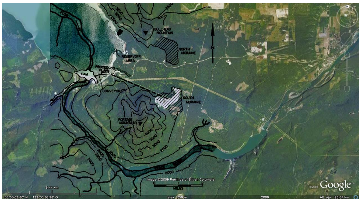
Figura 3.13: Sector de extracción del material, correas de transporte y ubicación de la presa (modificado de Low and Lyell, 1967 y Google Earth, 2008)
