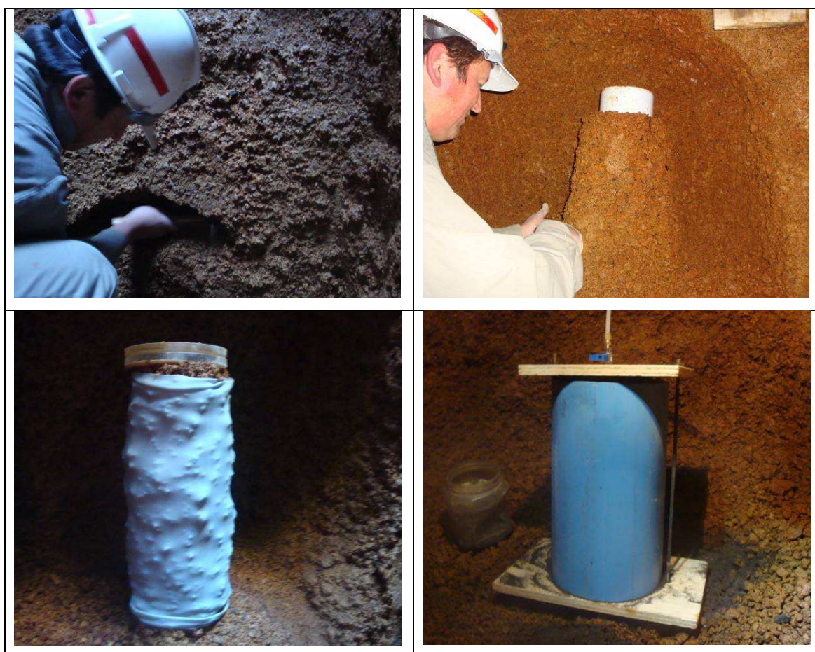
Figura Nº 26: Secuencia de Extracción de muestras inalteradas (gentileza Ingendesa S.A).
