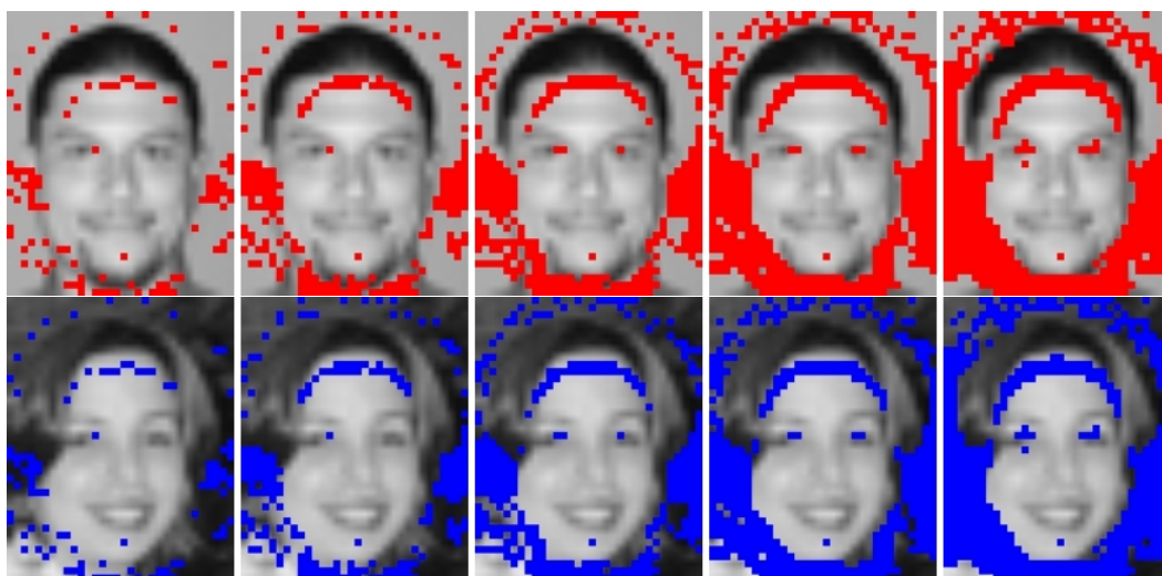
Figura 5.11: Imágenes originales de tamaño 32x40, un hombre y una mujer, para la base de datos Web con 100 a 500 características seleccionadas para la clasificación de género, con el algoritmo CMIFS.
