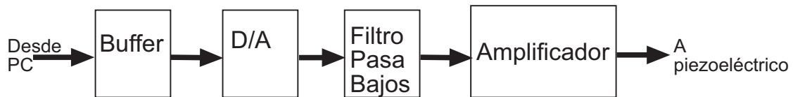
Figura 3.8: Bloques esenciales del circuito que convierte las señales digitales desde el PC a señales de voltaje apropiadas para el piezoeléctrico.
