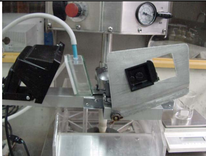
Figura N° 5.3: Instalación del muestreador de burbujas.
