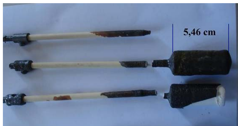
Figura 36: Husos utilizados en las pruebas con \text{Cu}_2\text{O}
