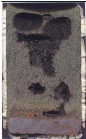
Figura 27: Vista interior del crisol utilizado para la escoria A1
