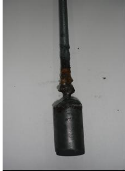
Figura 17: Fotografía del huso utilizado en las mediciones de viscosidad de la escoria madre A
