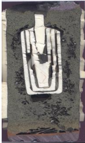
Figura 35: Vista interior del crisol utilizado para la escoria B2
