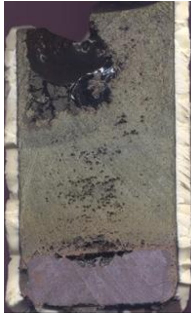
Figura 32: Vista interior del crisol utilizado para la escoria B1
