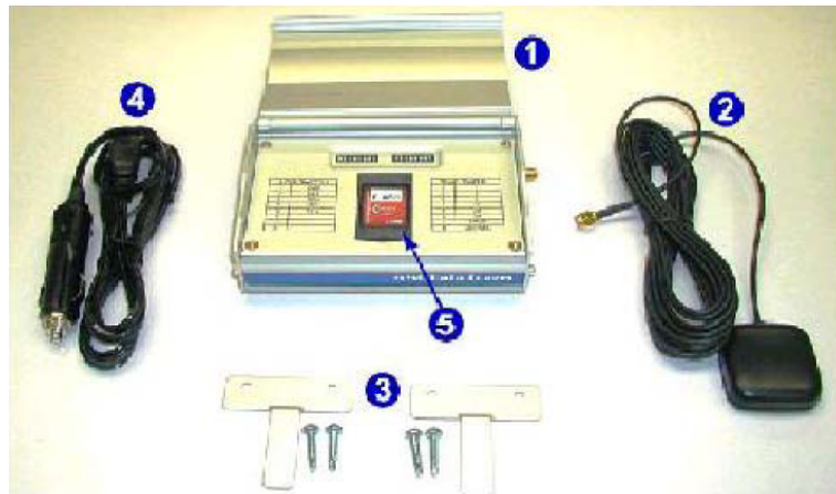
Figura 3.2: 1) GPS. 2) Antena. 3) Sistema de sujeción. 4) Conexión a fuente de energía. 5) Tarjeta de Memoria[1]
