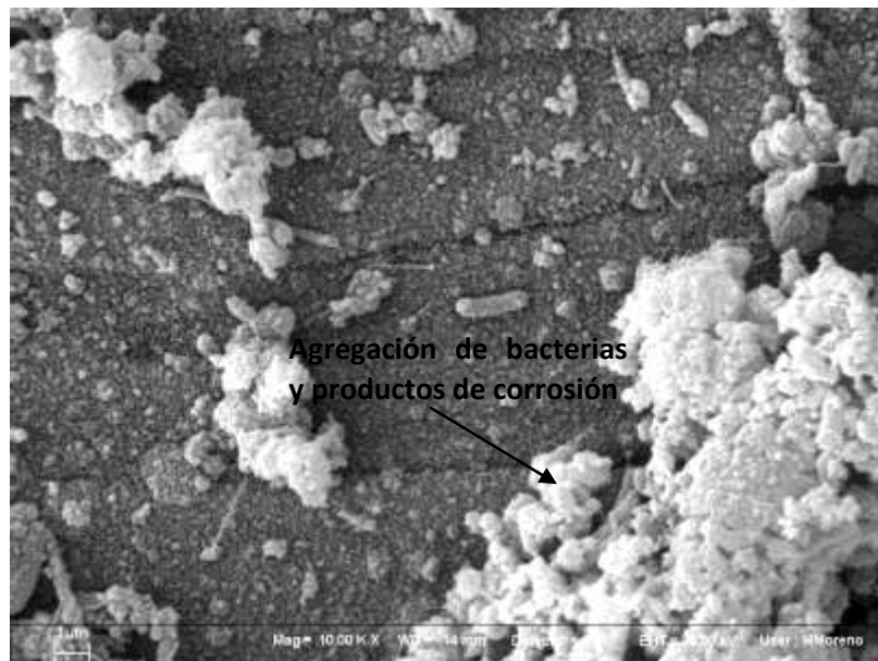
Fotografía 3.23: Superficie de Acero bonificado SAE 4340 tras 10 días de incubación en el reactor
