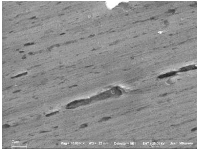
Fotografía 3.21: Superficie de Acero bonificado SAE 4340 previo a la incubación en el reactor
