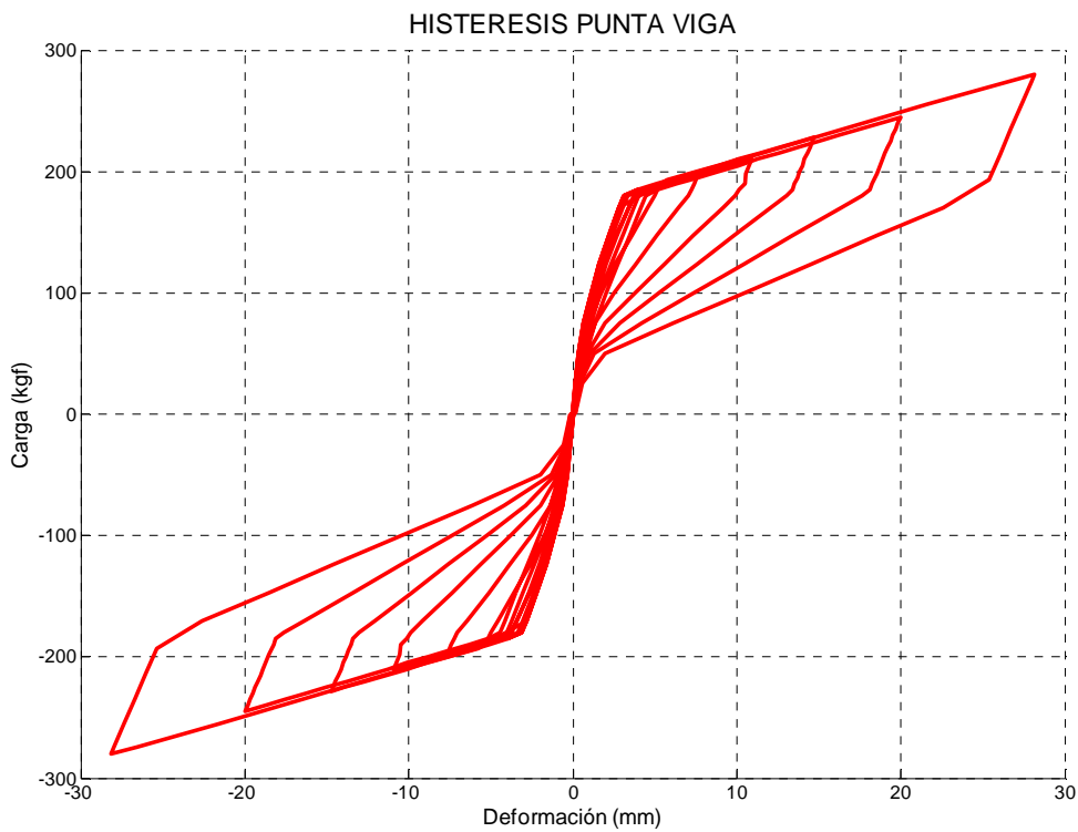
Figura 5.14: Histéresis de la punta de la viga – giros de 0,375 a 3%
