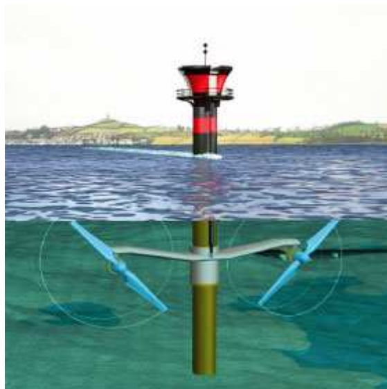
Figura 3.2: Esquema de turbinas accionada por corrientes marinas.
