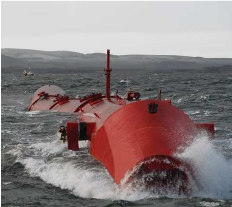
Figura 4.1: Equipo Pelamis instalado.
