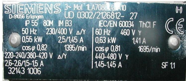
Figura 3.3. Datos de placa del Motor.
