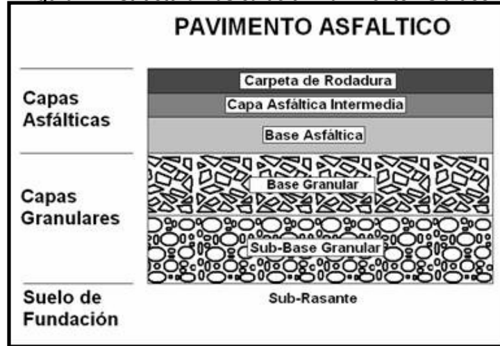
Figura 2 - Estructura Básica de un Pavimento Asfáltico.
