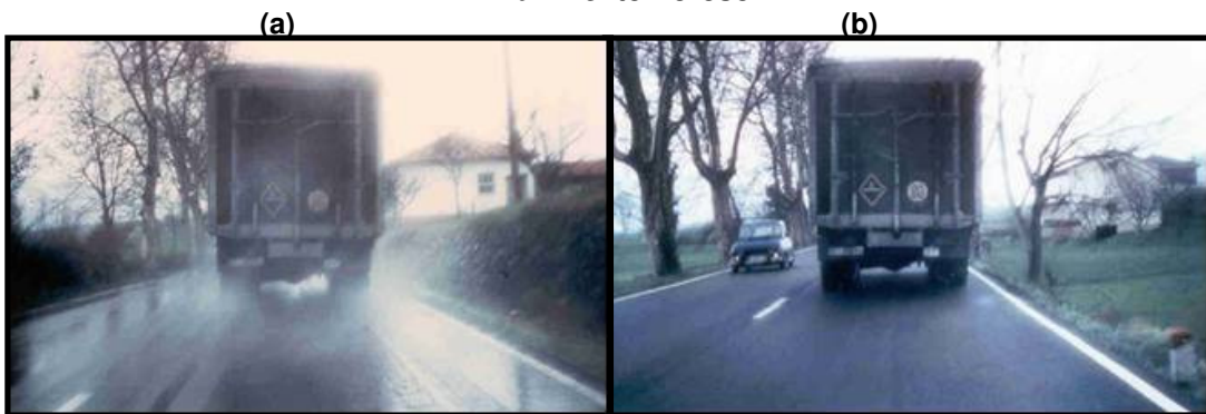
Figura 14 - Comparación de proyección de agua en: (a) Pavimento Tradicional, (b) Pavimento Poroso.
