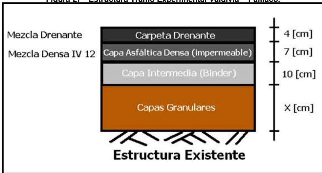
Figura 27 - Estructura Tramo Experimental Valdivia – Paillaco.
