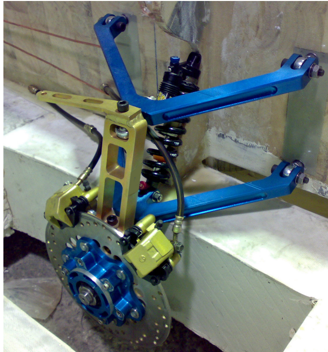
Figura 9.3: Suspensión Eolian montada en chasis
