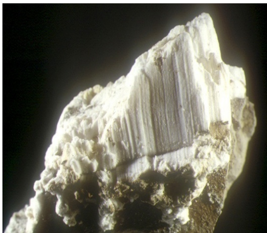
Figura 3-5: Sulfato de Magnesio
