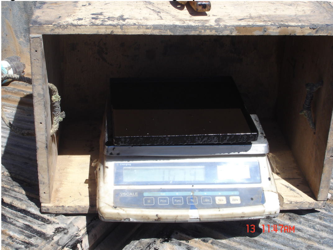
Figura 21: Cálculo de dosificación según peso de la muestra
