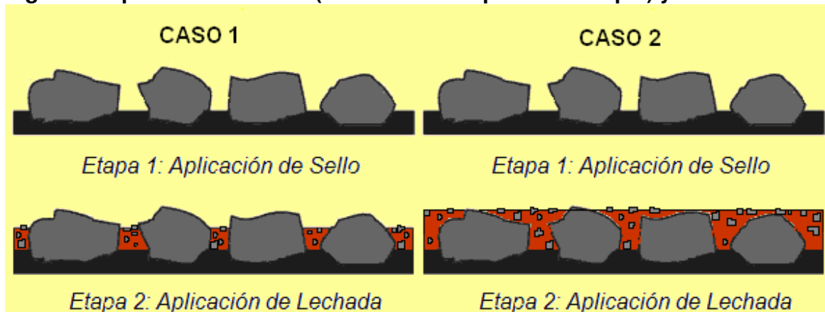
Figura 1: Aplicación de Sello (Tratamiento Superficial Simple) y Lechada Asfáltica
