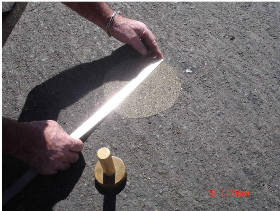
Figura 26: Medición de diámetros en distintas direcciones
