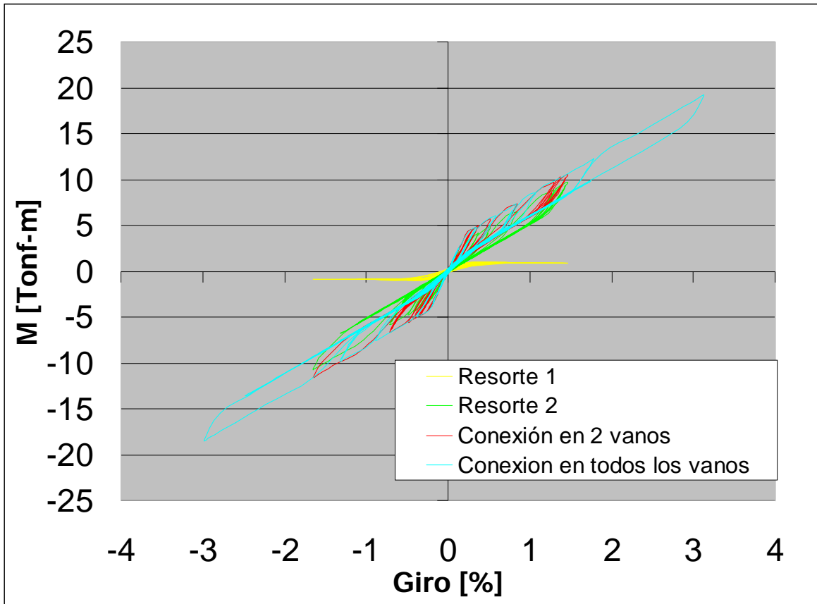
Fig. 6.52: Comportamiento de la conexión con SMA para la estructura con SMA en los dos vanos extremos.
