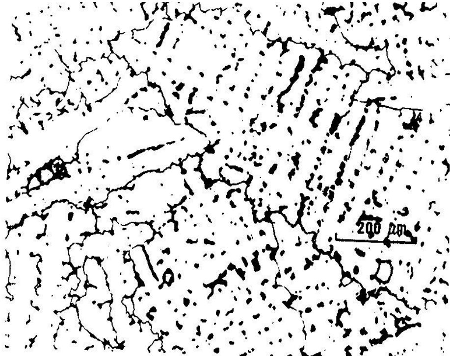
Figura 3.1 Aleación de Co-Cr-Mo micro fundida, bruta de fusión mostrando la segregación de los carburos inter dendríticos. [4]
