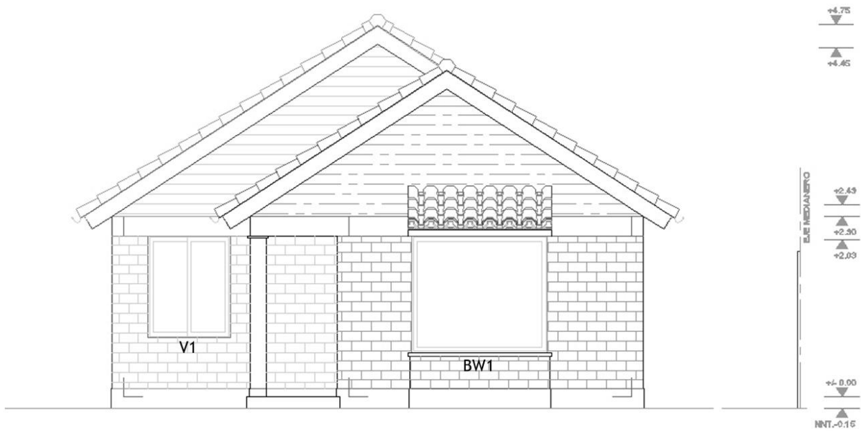
Figura B.7.: Elevación principal vivienda 1 piso
