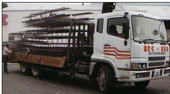
Figura N° 4: Transporte de armadura prefabricada [18].
