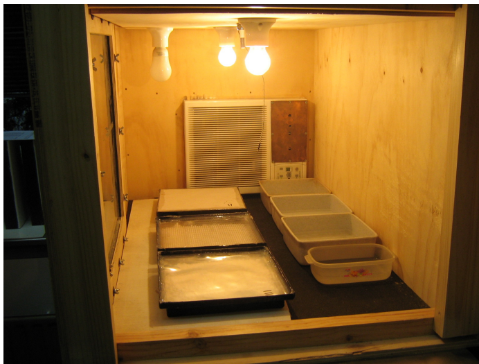
Figura C.2: Interior cámara de ensayo con las probetas ya instaladas.
