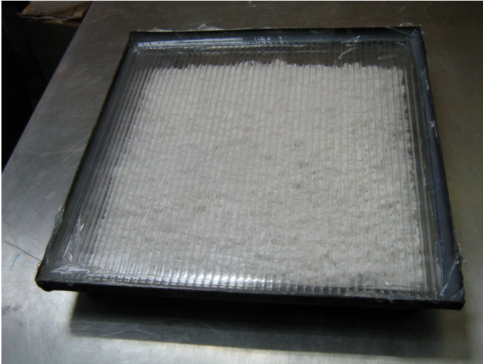
Figura C.4: Recipiente con la muestra de policarbonato ya instaladas.
