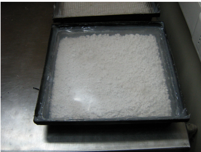
Figura C.6: Recipiente con la muestra de polietileno ya instalada.
