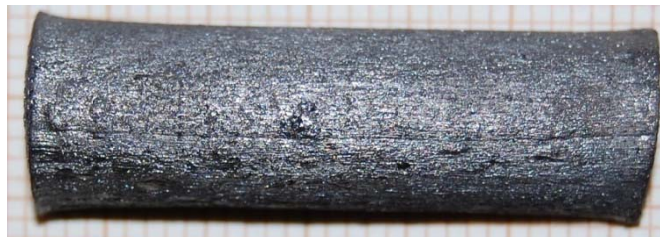
FIGURA 13. MUESTRA DE PINO IMPREGNADA CON SOL-GEL UTILIZANDO VACIO Y PRESIÓN, Y LUEGO PIROLIZADA. POSEE ASPECTO PLATEADO.
