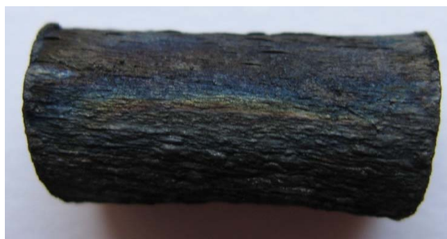
FIGURA 15. MUESTRA DE HAYA IMPREGNADA CON SILICATO DE SODIO Y POSTERIORMENTE PIROLIZADA
