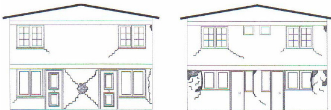
Figura 5.15 Esquema de daños en el caso 111, “ (b/A) \times 100 = 43\% ”
