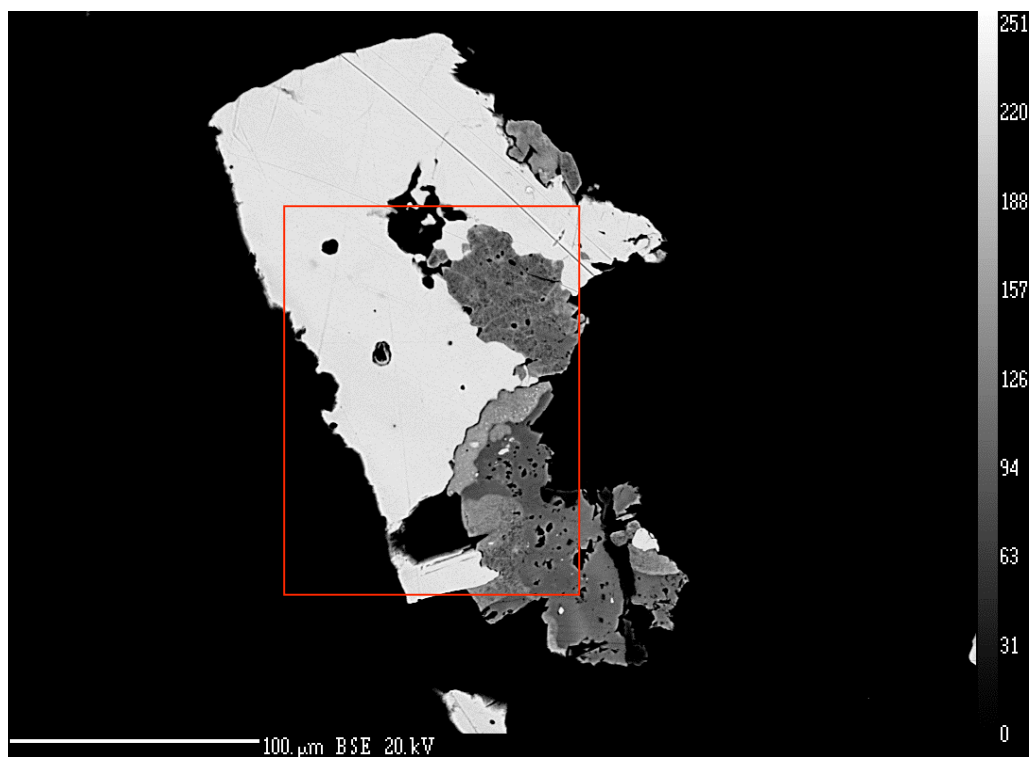
Figura 18: Imagen BSE de un grano de calcosina de la muestra ML-1 de Mantos de la Luna con fases cloruradas. En cuadro rojo área del mapeo elemental de la Figura 19.
