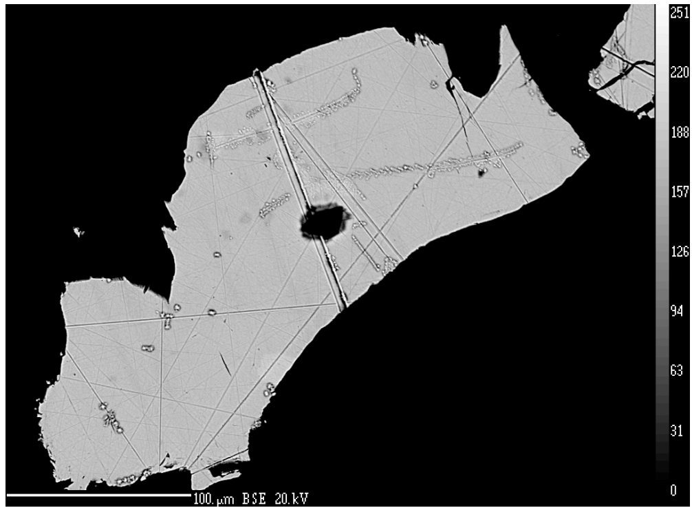
Fig A: grano de calcosina (MB-14) sin niveles detectables de Ag para EMPA.
