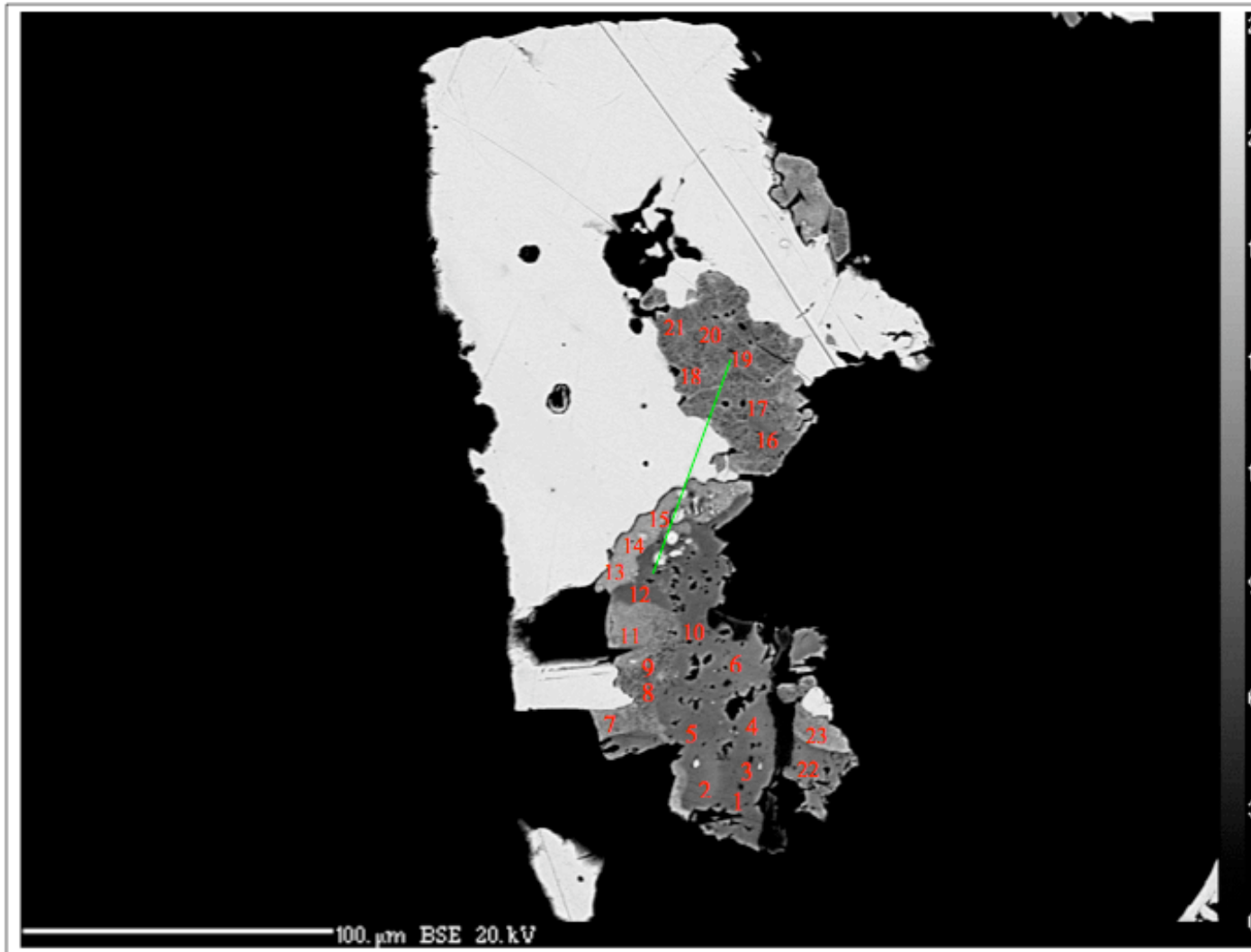
Figura G: Grano de calcosina ML-1 de Mantos de la Luna con puntos para fases cloruradas.
