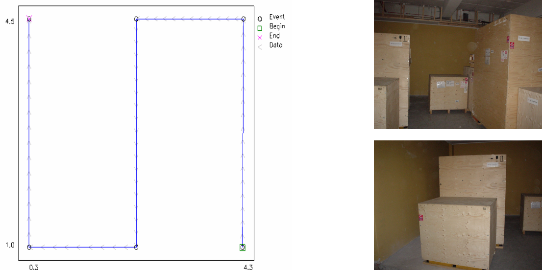
Figura 4.22: Estrategia de medida de la inducción magnética “Post- Blindaje Generalizado” y fotografías de la Sala TEM llena con las cajas de los componentes del microscopio – EMDEX II midiendo a una altura Z = 1.5\text{m} . Luminarias y equipos de aire acondicionado encendidos.
