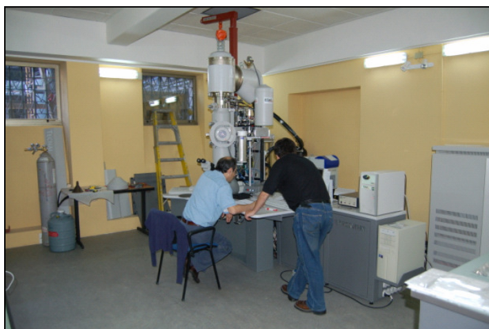
Figura 6.2: Fotografía del microscopio electrónico de transmisión, instalado y estando operativo en la Sala TEM.
