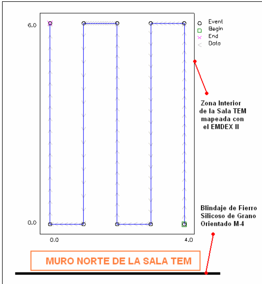
Figura 6.6: Estrategia de medida de la onda transmitida al interior del muro Norte de la Sala TEM, el cual ha sido blindado con Fierro Silicioso de Grano Orientado M-4.
