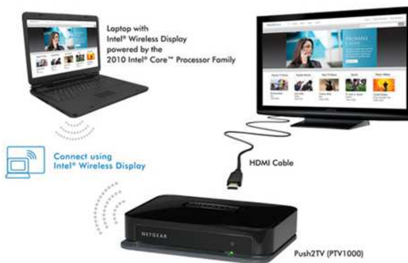
Figura 1. Esquema que resume el funcionamiento de WiDi
