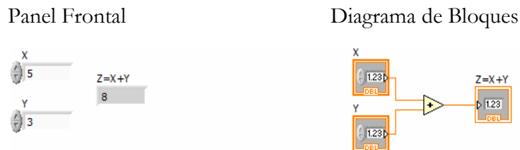
Figura 53 Relación entre los elementos del panel frontal y el diagrama de bloques.
