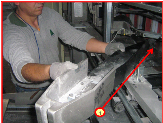
Para colocar plegador fijo de cabeza llevar plegador en esta direccion tal como lo muestra la figura 1
